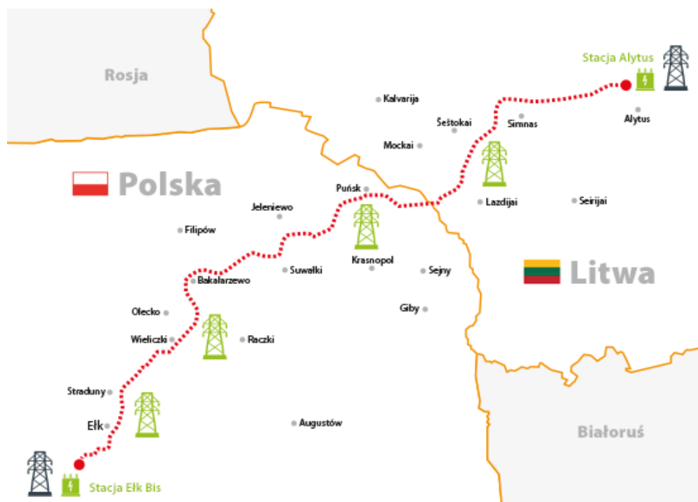
Rysunek 17. Przebieg linii energetycznej 400 kV
